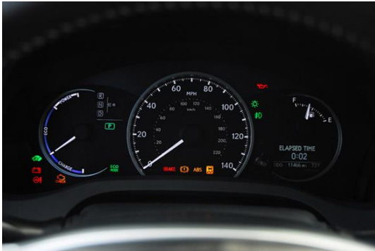
Figura 29. Síntomas de fallo en RED reflejados en el clúster del automóvil.
